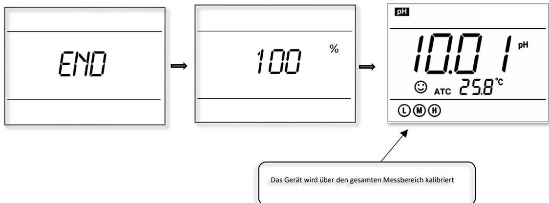
**Hinweis - Wenn die Kalibrierung mit dem eingesetzten DHS-Sensor durchgeführt wird, wird diese in dem internen Speicher des Sensors gespeichert und nicht in dem des Gerätes. Der kalibrierte Sensor kann dann auf anderen zugelassenen Geräten verwendet werden**
